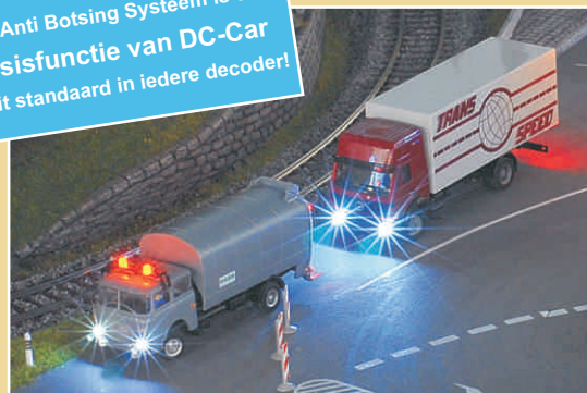
Verlichtingbalk met richtingaanwijzers, achterlichten, remlichten en infrarood zenders
